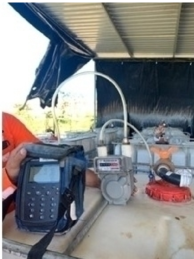
Figura 5 - Medição da vazão e composição do gás nos reatores instalados na GNR/ASMOC. Fonte: Os autores (2024).
