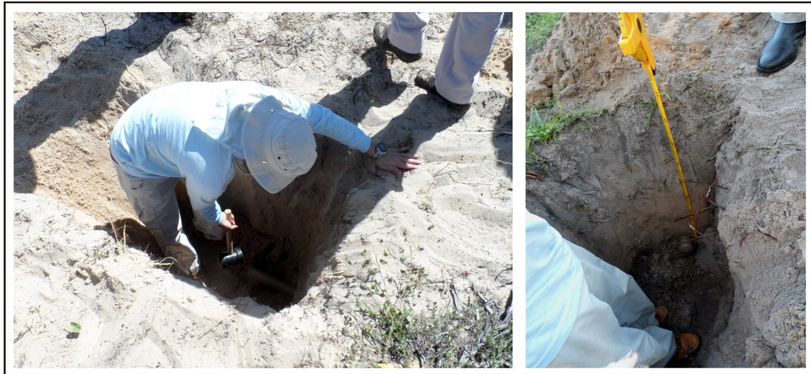
Figura 5 – Procedimentos em campo de amostragem para datação por LOE.
